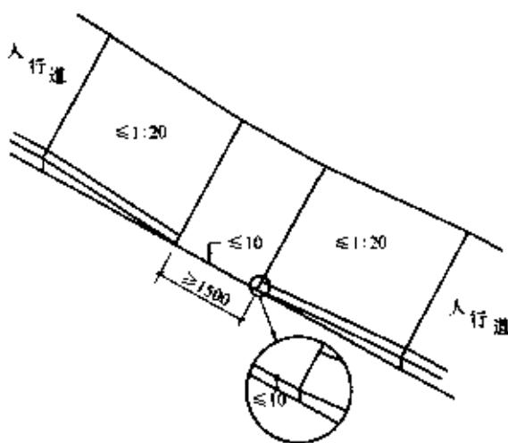
图 3-1 全宽式单面坡缘石坡道
